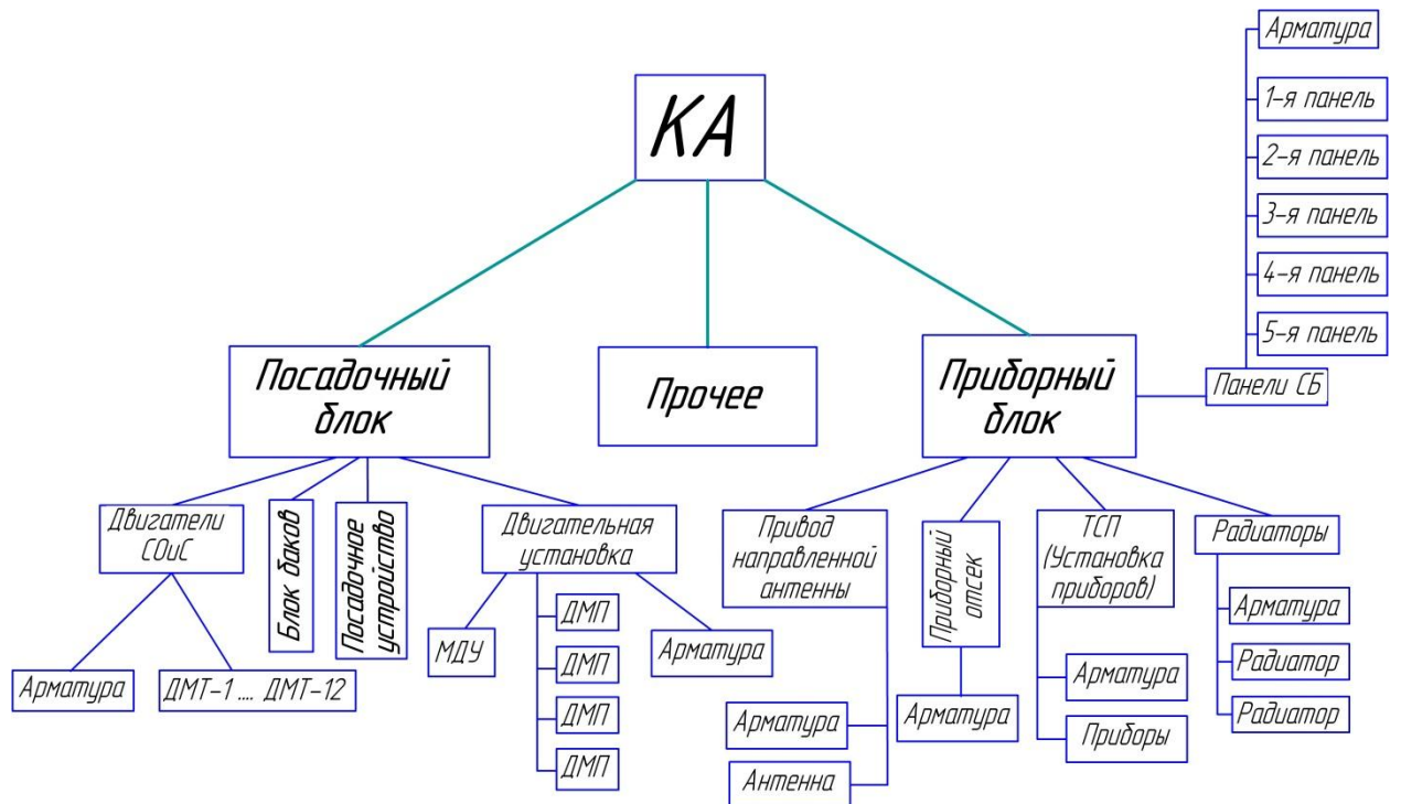
Рисунок 20 – Директивная схема сборки КА
